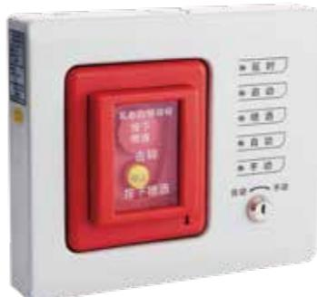
编码型手自动转换开关也是气体释放控制中的重要设备，如果开关处于手动状态，则无论探测器如何报警系统都不会喷放；如果开关处于自动状态，则喷放就会按照设定的逻辑自动执行。一般当人员进入被保护区域时，将开关置于手动状态，以确保进入人员的生命安全。GS8204也是一款编码设备，接入控制器总线，占一个设备地址。
