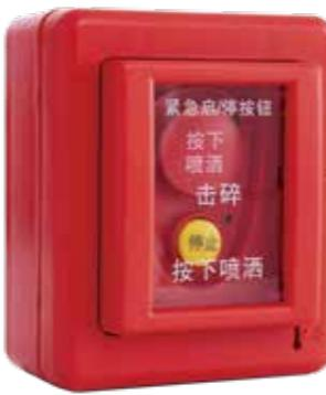
编码型紧急启停按钮是气体释放控制中的重要设备，它分为紧急启动和紧急停止两个按钮：紧急启动按钮可以在探测器未报警或者探测器已报警，但系统还在预设的延时阶段中强行启动喷放；紧急停止按钮则是在延时阶段立刻中止喷放的保护性设施。GS8202B的设计上都采用了多重保障措施，保证这两个按钮不会因为线路或者其他干扰因素导致系统误动作。
