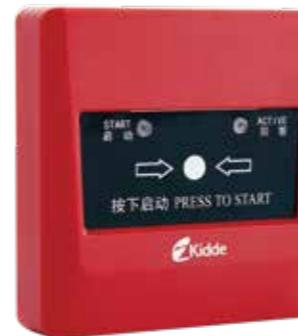
J-SAP-M-GS8030X是一款消火栓按钮, 有较高的防护等级。直接按下按片, 此时消火栓按钮的红色启动指示灯亮, 表明已向消防控制室发出了报警信息, 火灾报警控制器在确认了消防水泵已启动运行后, 就向消火栓按钮发出命令信号点亮绿色回答指示灯。
