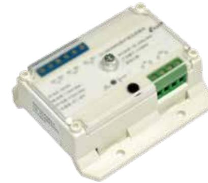
GS-MOD802扬声器监视模块，用于总线制消防广播系统中正常广播和消防广播间的切换。模块在切换到消防广播后自回答，并将切换信息传回火灾报警控制器，以表明切换成功。
