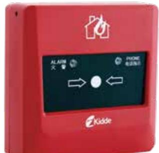
J-SAP-M-GS8030是一款室内型手动火灾报警按钮, 安装在公共场所, 本报警按钮含电话插孔。当人工确认发生火灾后, 按下报警按钮上的按片, 即可向控制器发出报警信号, 控制器接收到报警信号后, 将显示出报警按钮的编码信息并发出报警声响, 将消防电话分机插入电话插孔即可与电话主机通讯。
