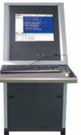
GS8060B型消防控制室图形显示装置作为GS8000火灾报警系统的一个重要组成部分,作为一台高性能琴台式计算机,它为消防控制室值班人员提供更为便捷的人机交互方式,既能直观显示和查询整个火灾报警系统甚至一些关联系统的运行状态,也能进行消音等常用的操作。与之相连的大型商用打印机可以实时打印当前信息,也能将计算机中存储的历史数据一一打印出来,数据存储及信息量远非控制器配置的嵌入式打印机可比。坚固的软硬件设计也保证了图形装置在存在电磁干扰的复杂环境中的稳定运行。
