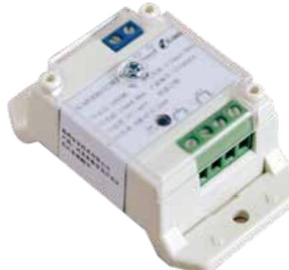
GS-MOD8032隔离器，主要用于隔离分支型总线上发生短路的部分，保证总线上的其它设备正常工作。待故障修复后，总线隔离器可将被隔离出去的部分重新纳入系统。并且，使用隔离器便于确定总线发生短路的位置。
