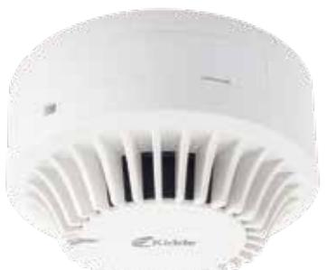
JTY-GDM-GS6010为点型光电感烟火灾探测器,由于探测器自带单片机可以独立探测烟雾及报警,灵敏度可调,巡检灯是否巡检闪烁可调。
